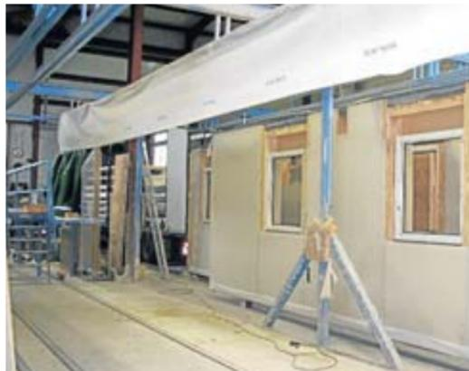
Ein Einblick in die weitläufigen Werkshallen: Hier fertigen die Mitarbeiter Wände, Decken und Dachstühle witterungsunabhängig vor...
